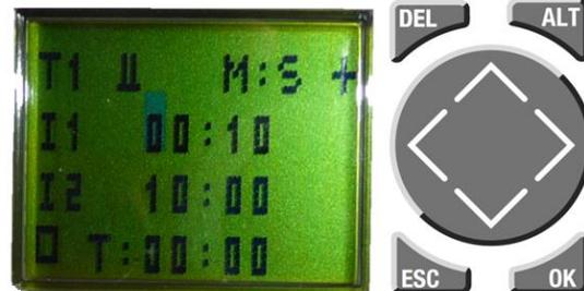
Mit der Pfeiltaste kann der gewünschte Parameter ausgewählt und mittels OK Button bestätigt werden.
