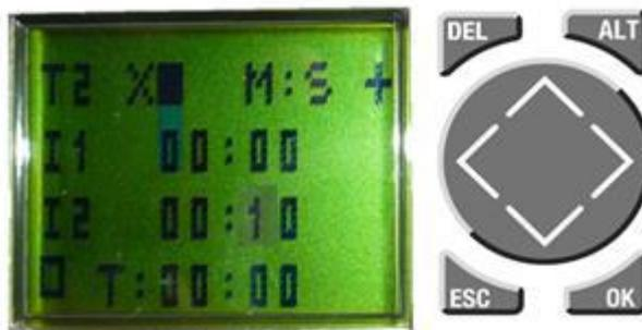
Mit der Pfeiltaste kann der gewünschte I 2 Parameter ausgewählt und mittels OK Button bestätigt werden.
