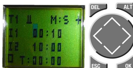
Mit der Pfeiltaste kann der gewünschte Parameter ausgewählt und mittels OK Button bestätigt werden. Durch die Pfeiltaste kann nun die Zeit verändert und mit OK gespeichert werden. Mittels ESC gelangt man wieder in das Timer-Menü und bei nochmaliger Betätigung in den MENÜ Bildschirm.
